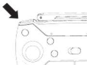
Эта кнопка на пульте управления служит для фотосъемки (короткое нажатие) и включения/выключения записи видео (длительное нажатие). При использовании WiFi приложения для фотосъемки на экране смартфона используйте значок «Фото», и значок «Камера» для записи видео. При использовании пульта управления для пилотирования дрона эту кнопку пульта можно также использовать для включения фото/видео на камере WiFi версии.
