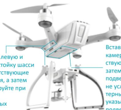
Вставьте подвес камеры в соответствующие отверстия, затем сдвиньте подвес назад, пока не услышите характерный щелчок, указывающий, что подвес зафиксирован на месте.
