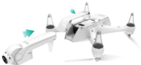
Нажмите вниз кнопку блокировки, чтобы освободить крышку люка на нижней части дрона, а затем сдвиньте ее вперед и снимите ее.
