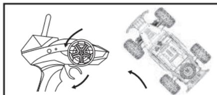
3. Поворот влево при движении вперед: нажмите курок газа пульта на себя и поверните рулевое колесо против часовой стрелки - автомобиль повернет влево.
