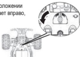
Если при нейтральном положении руля машина поворачивает влево, устраните отклонение, перемещая рычаг триммера вправо, пока машина не станет ехать прямо.
