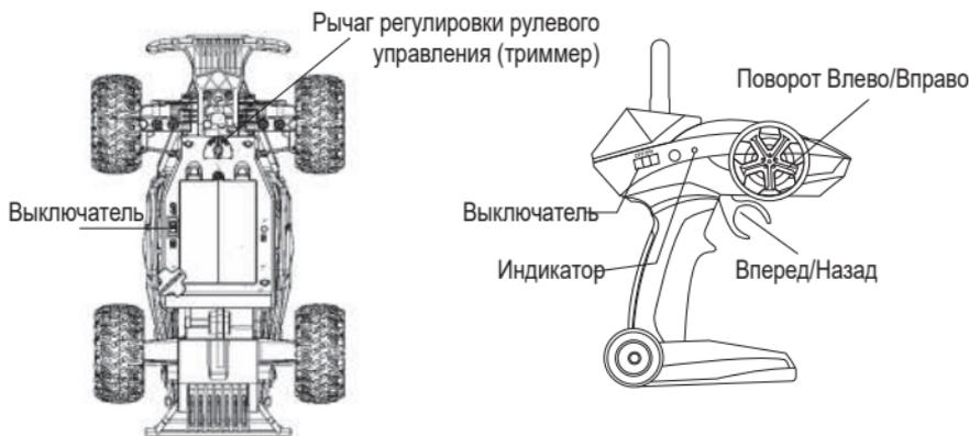
Если при нейтральном положении руля машина поворачивает вправо, устраните отклонение, перемещая рычаг триммера влево, пока машина не станет ехать прямо.
