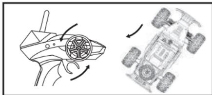
5. Поворот влево при движении задним ходом: переместите курок газа от себя и поверните рулевое колесо против часовой стрелки - автомобиль двигаясь назад повернет влево.
