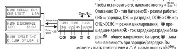
Экран отображает текущее состояние процесса. Чтобы остановить его, нажмите кнопку «**Mode/Esc**»; Описание: Ⓐ - тип батареи; Ⓑ - режим работы; CHG = зарядка, DSC = разрядка, DCHG>CHG или CHG>DCHG = режим циклирования, Ⓒ - прошедшее время; Ⓓ - ток зарядки/разрядки батареи; Ⓔ - общее напряжение батареи; Ⓕ - закаленная емкость при зарядке/разрядке. Вы можете узнать температуру и  $\Delta V$ , нажав кнопку «**Enter/Start**».
