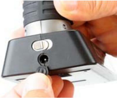
Разъем для зарядного устройства находится непосредственно под выключателем. Если используются аккумуляторы, то они могут быть заряжены без вынимания из батарейного отсека.
