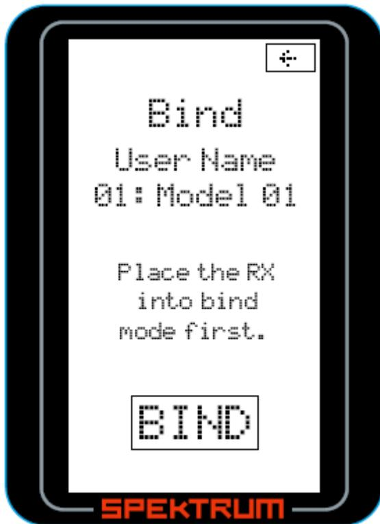
Во время привязки приемника к передатчику вы сообщаете приемнику уникальный код передатчика GUID и сохраняете настройки Failsafe. Когда приемник привязан к передатчику он может принимать команды только от этого передатчика и только когда на передатчике выбрана модель при которой производилась привязка (технология ModelMatch™). Также во время привязки передатчик определяет тип приемника и устанавливает по какому протоколу DSM2 или DSM он будет работать.
